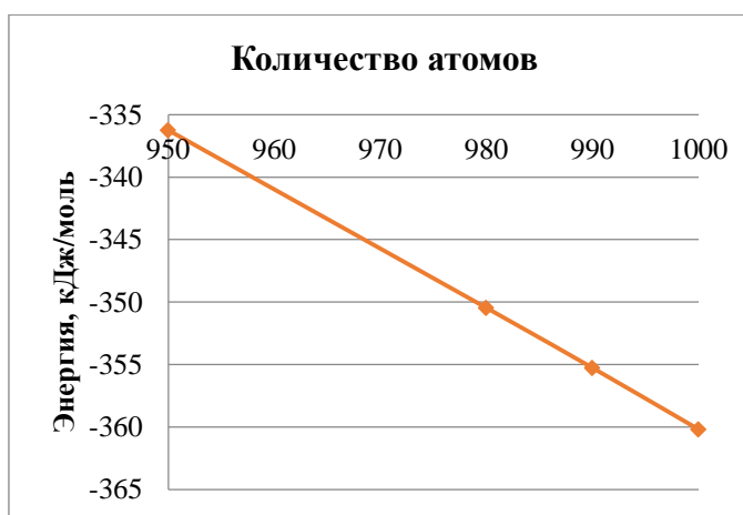
Рисунок 23 – Зависимость энергии системы от количества атомов
